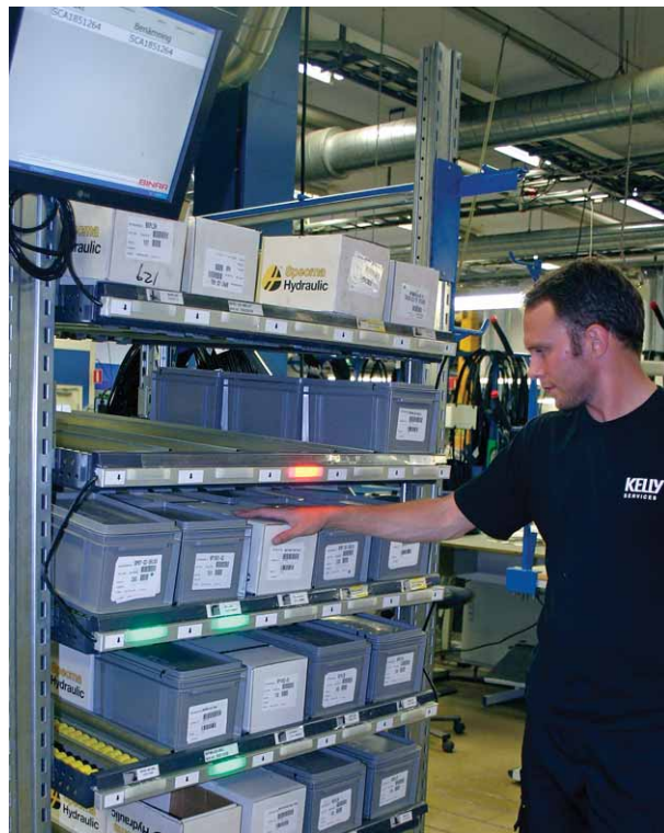
ELIN Pick-to-Light kvalitetssäkrar på Specma Hydraulics i Göteborg. På hyllkanterna sitter LP350 plockindikeringar. Skärmen visar produktinformation och monteringsinstruktioner.
